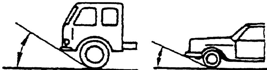
Рисунок 2. Угол съезда
