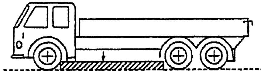
Рисунок 5. Дорожный просвет под одной осью
