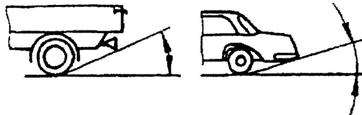
Рисунок 3. Продольный угол проходимости
